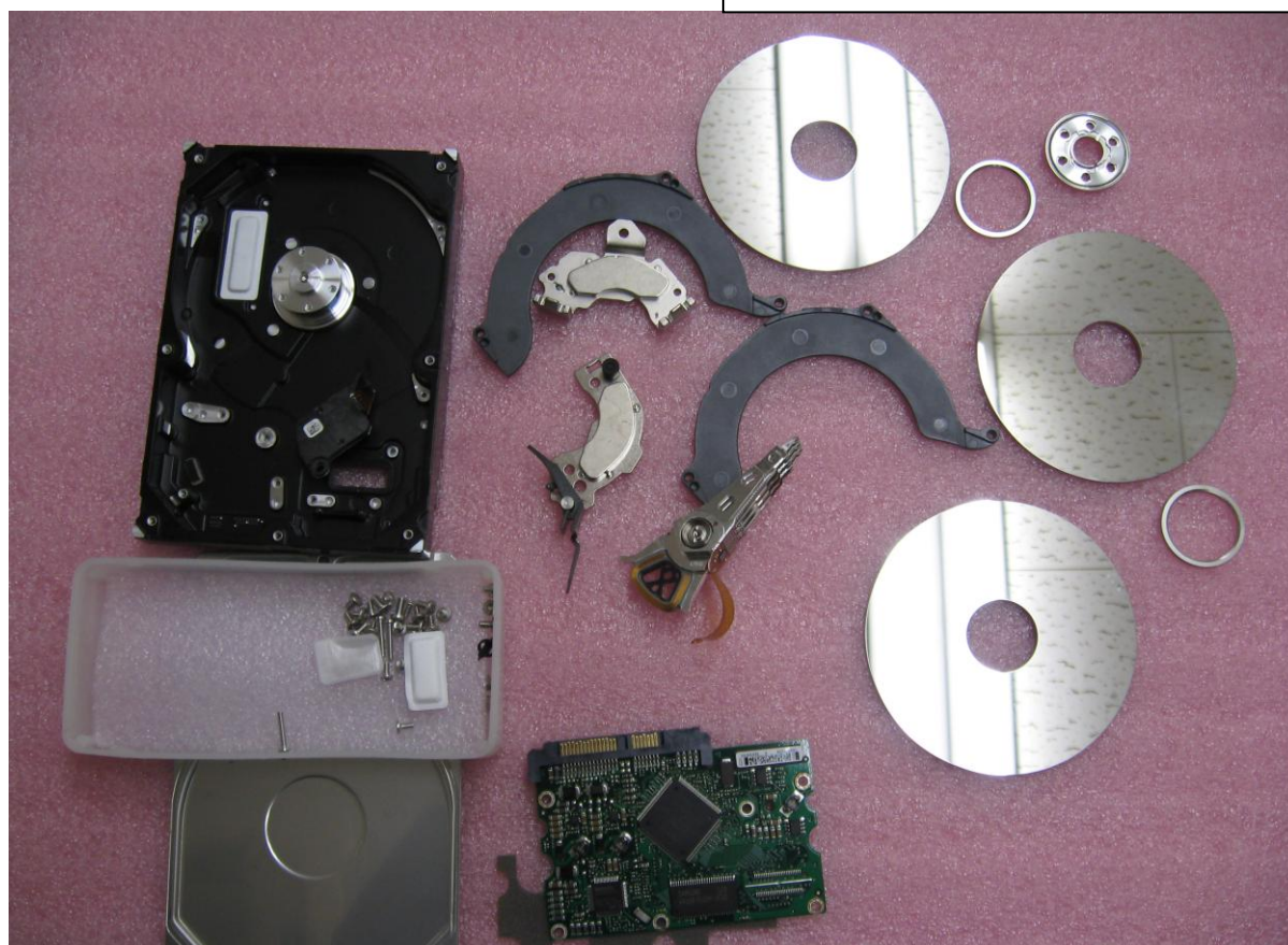
Seagate 400GB SATA HDD 解体例
