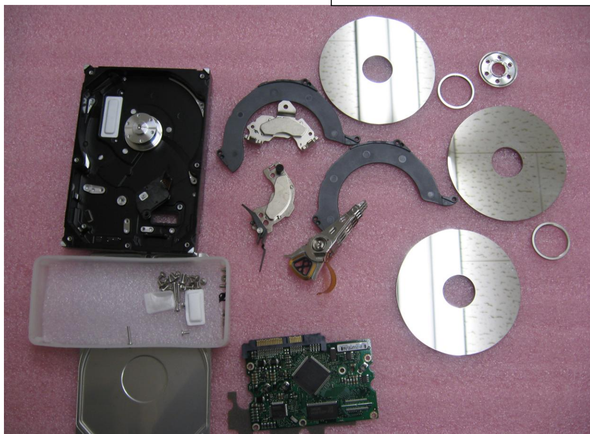
Seagate 400GB SATA HDD 解体例
