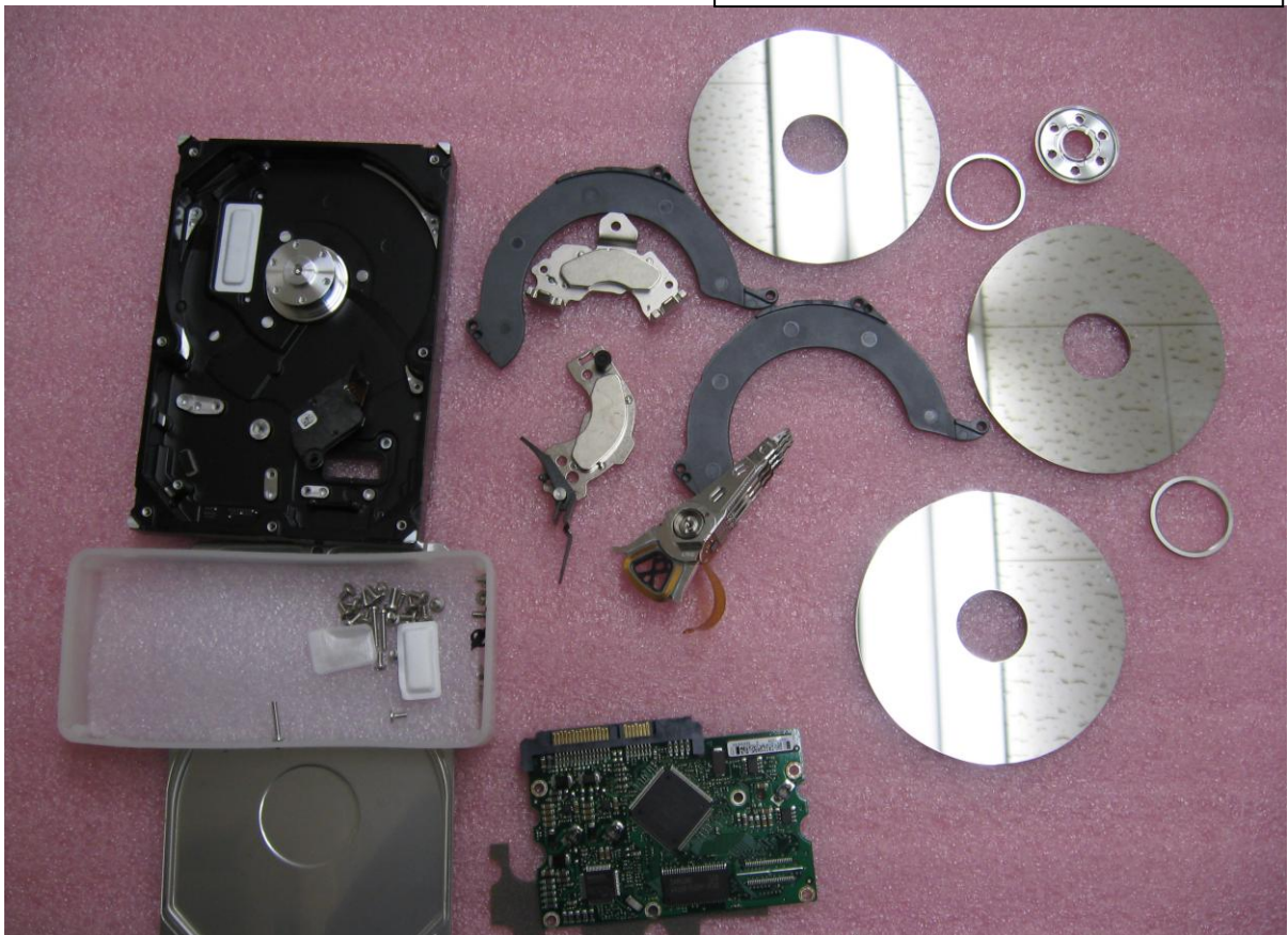
Seagate 400GB SATA HDD 解体例
