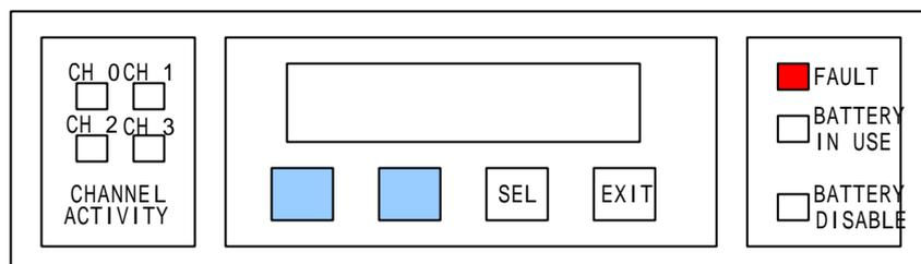
コントローラおよびディスク装置に異常が検出された場合、コントローラよりブザー音が発生します。この場合、直ちに弊社までご連絡いただき、次に前面操作パネルより を同時に押しブザー音を停止させます。
