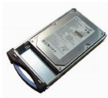
2. ドライブを載せる 静電気に注意
